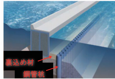
図1 鋼管杭式補強工法の概要
