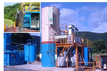
トンネル掘削時の濁水処理汚泥の改良
