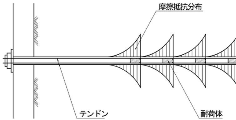
図 荷重分散型本設アンカーの荷重伝達イメージ
