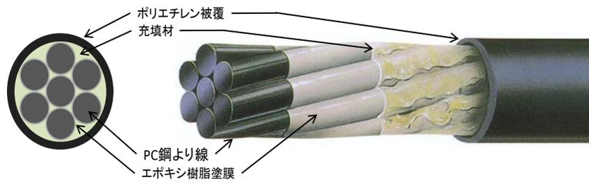
図 PE 被覆全素線塗装型 PC 鋼より線
