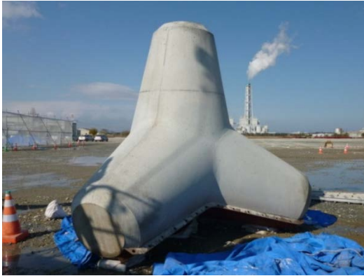
高耐久海水練りコンクリートによって製造された消波ブロック・根固ブロック
