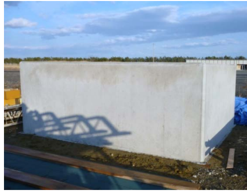
高耐久海水練りコンクリートによって製造された消波ブロック・根固ブロック
