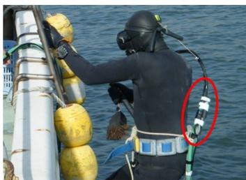
写真-1 潜水士へのセンサ取付状況
