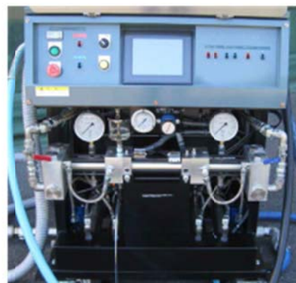
写真-3 自動監視制御吹付システム
