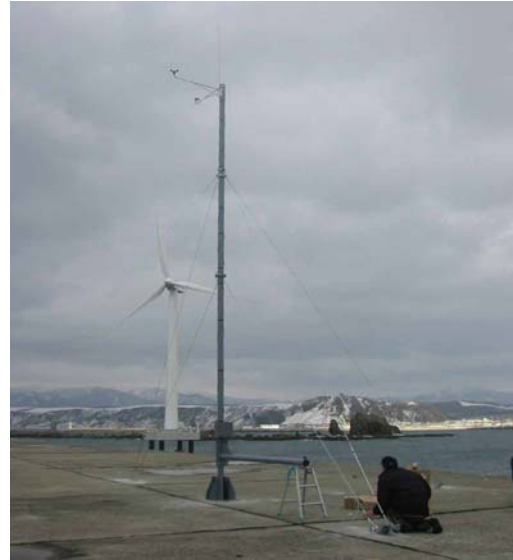
写真-4 キャリブレーション用 風杯型風速計・矢羽型風向計
