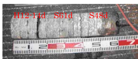
写真-2 舗装コア採取例
