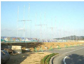
図-1 海洋短波レーダ局アンテナ (有明海・宇土局)
