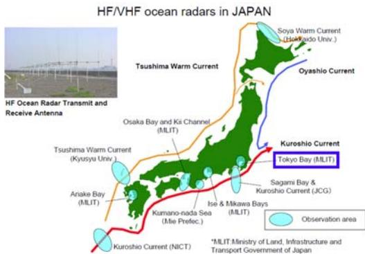
図-3 国内における海洋短波レーダの稼働状況
