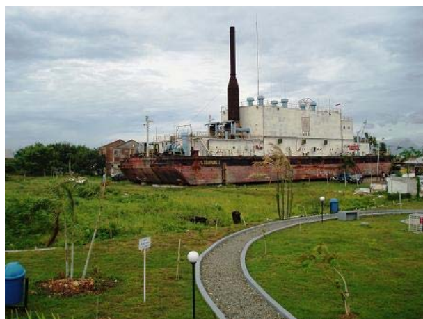
写真-1 津波で内陸へ3kmも流された発電用バarge船
