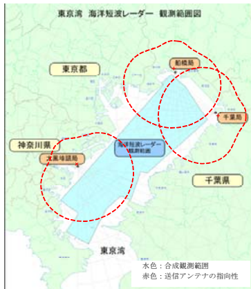
図-5 東京湾の海洋短波レーダの設置状況
