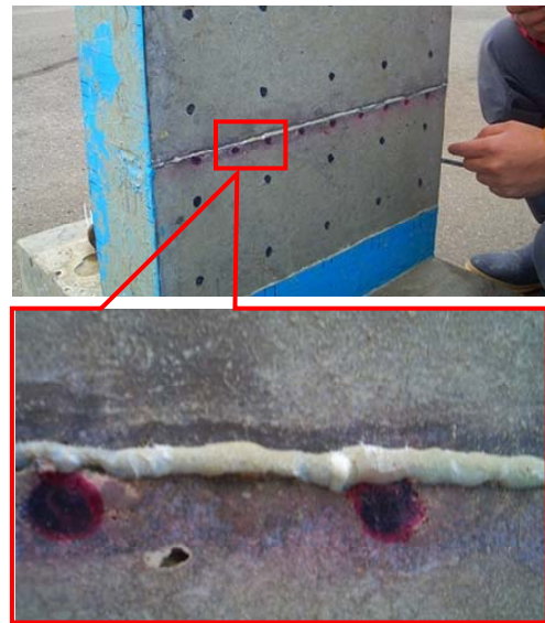
写真-1 供試体 No. 2 (基本) の析出状況
