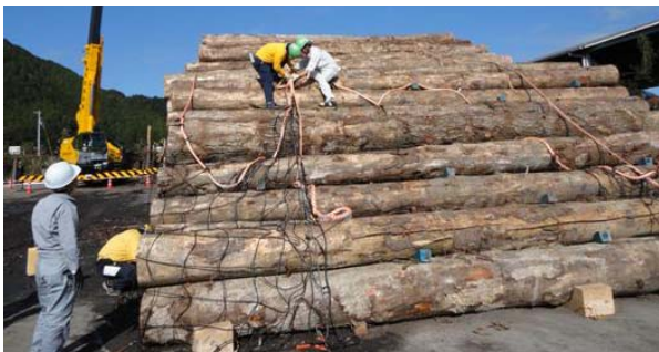
図-4 固縛施設現地実証実験（作業性の確認）
