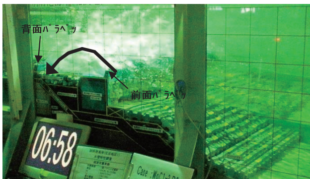
写真-5 越波流量の水理模型実験状況
