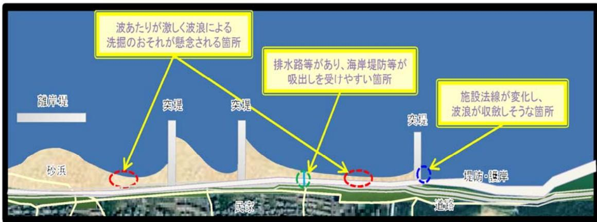
図-2 地形等により変状が起りやすい箇所のイメージ
