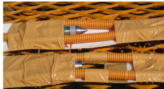
図-11 間隙水圧計の取り付け方法
