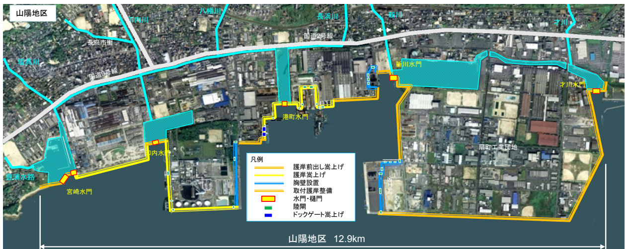
図-10 山陽地区の防護ラインと水門・陸閘等配置 (基本計画)
