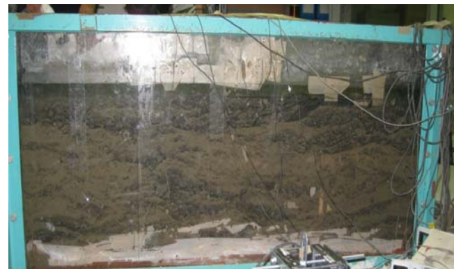
写真-2 加振後の計測状況
