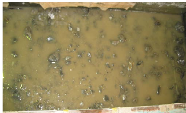
写真-3 加振後の地盤表面の状況 (試料-1 相似粒度)
