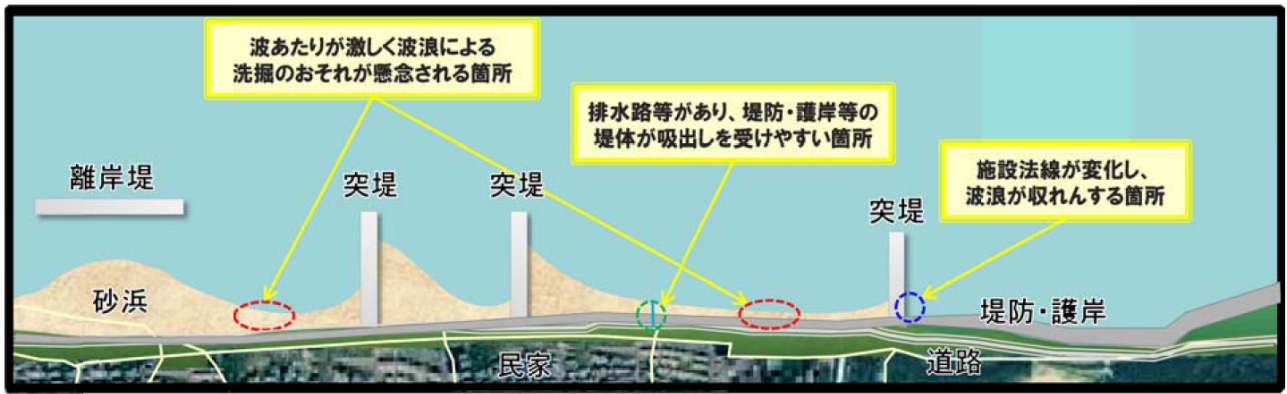
図-1 地形等により劣化や被災による変状が起りやすい箇所のイメージ
