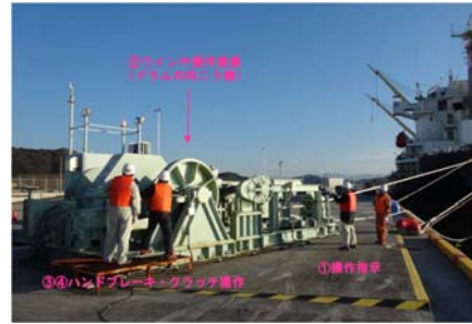
写真-1 長周期動揺低減システム
