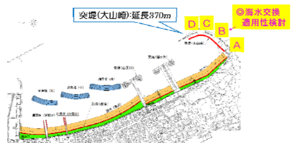
図-14 突堤区間の工区区分
