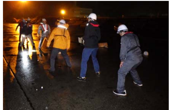
図-6 反復横跳びによる栈橋の強制加振状況
