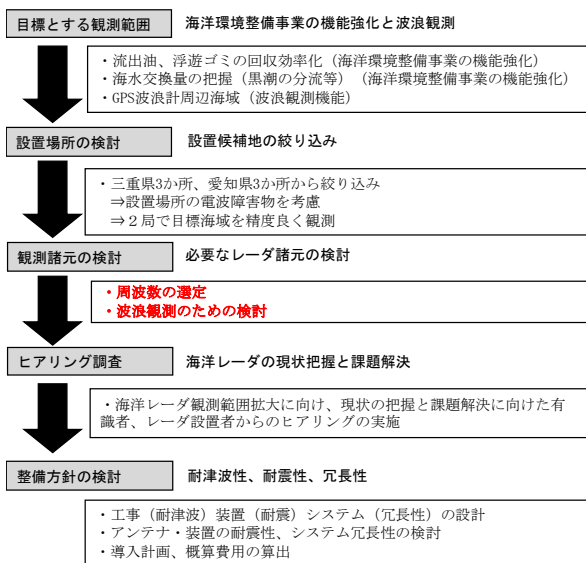
図-8 新局設置の検討の流れ
