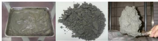
写真-1 浚渫土、転炉系製鋼スラグ、混合材
