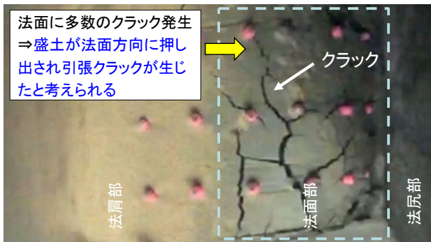
図-6 実験終了後の変形挙動法面部 [200-10.0%]
