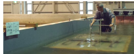
図-20 扉体の起立に支障のない土砂・へドロ堆積図と実験風景(下)
