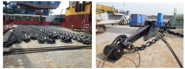
係留索 アンカー 写真-2 係留設備
