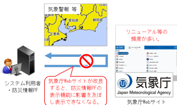
図-2 従来方式における気象庁情報の取得方法
