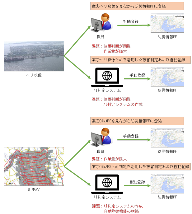
図-9 損傷判定・表示機能のシステム構想案概略図
