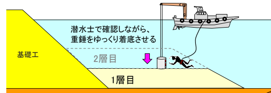
図-11 実現現場での重錘貫入試験の実施概要図
