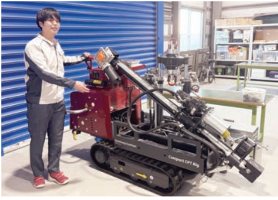
試薬噴霧機能付きCPTビデオコーン貫入試験器「WIT-video-CPT」
