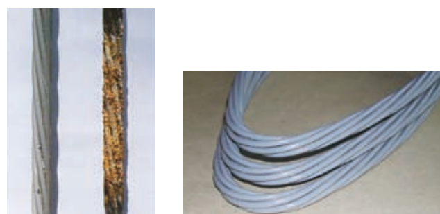
左：SCストランド 右：PC鋼より線 図5 乾湿繰返し試験
