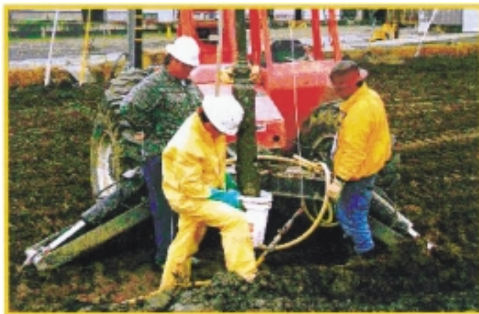
写真1-2 Wet Grab Sampler による試料採取
