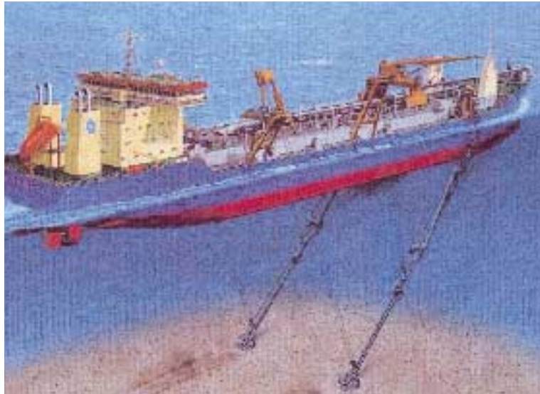
トレーリングサクシオンホッパー浚渫船 (TSHD) (Queen of Penta-Ocean: 20,000m³)
