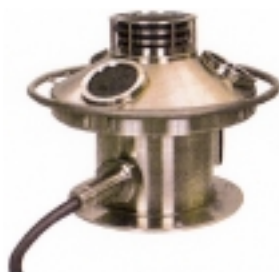
図2 海象計のセンサー部分
