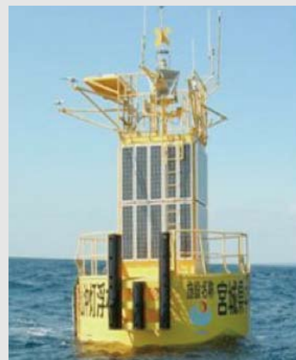
写真2 GPS波浪計の外観
