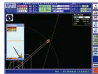
写真4 高さ管理システム画面
