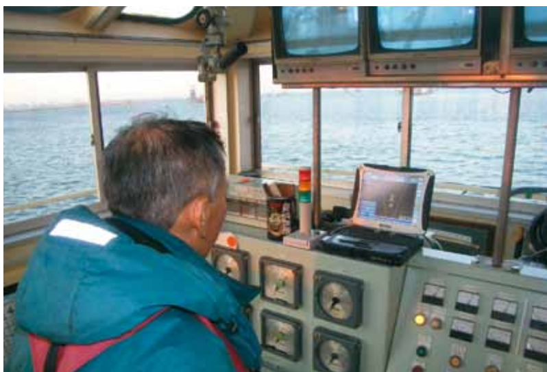
写真10 ジャケットの据えつけにはGPSで 正確な位置が決められる
