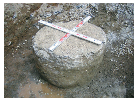
写真1 エコガイアストンの固結状況 （締固め施工・養生後の状況）
