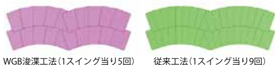
図3 仕上げ掘りの浚渫パターン(例)
