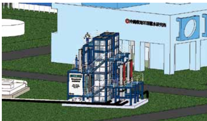
図4 沖縄県OTEC実証装置イメージ(沖縄県提供)
