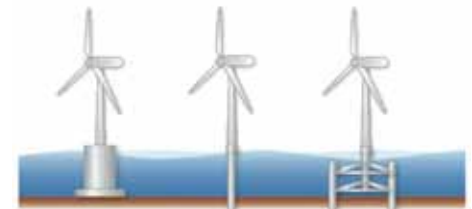
図2 着床式洋上風力発電の構造
