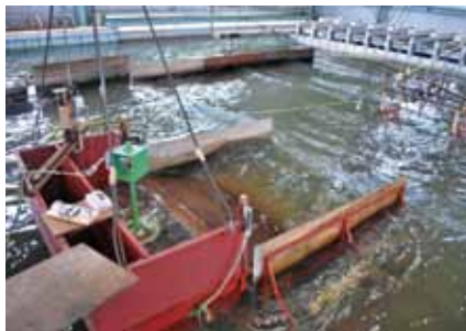
写真1 越波式波力発電装置の発電実験の様子
