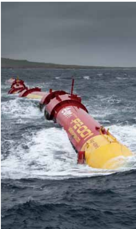
写真1 波力発電デバイスPelamis 提供：Pelamis社（参考情報 http://www.pelamiswave.com/ ）
