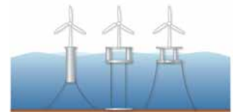
図3 浮体式洋上風力発電の構造
