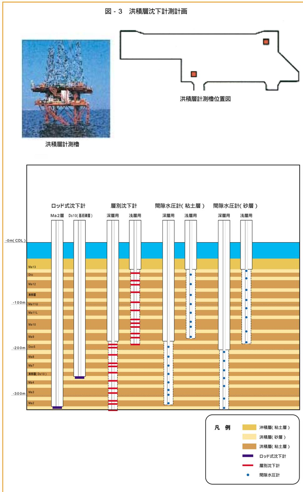
気伝送水圧式沈下計を三十七カ所設置（P.7 図 7 参照）して沈下を計測しています。計測された沈下量は、施工管理システムにより計算された埋立荷重による沈下計算と直ちに比較され、各地点における荷重履歴の作成・修正、沈下予測手法の高度化に利用されています。また、洪積層の挙動を計測するために、洪積層計測槽を二基設置し現地計測を行っています。
