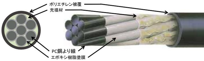
図5 PE被覆全素線塗装型PC鋼より線(SC-U1)
