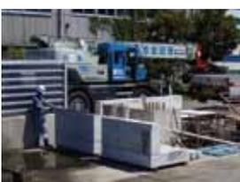
写真8 海洋環境でのL型ブロック曝露状況(港湾空港技術研究所)
