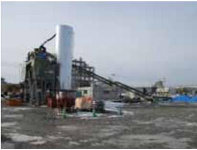
写真3 高耐久海水練りコンクリート製造設備
