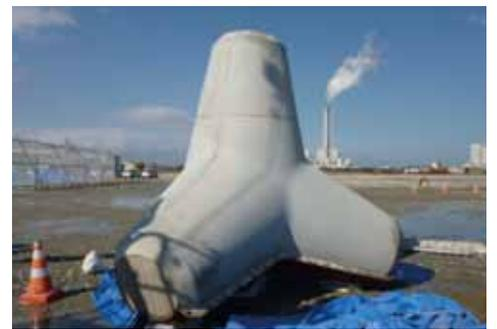
写真1 高耐久海水練りコンクリートにより製作された消波ブロック
