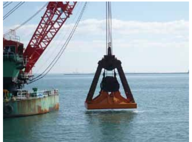
写真1 大型船に取り替えたプレート&フラットグラブ(BFG)
