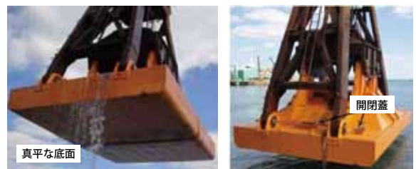
写真2 グラブのフラットな底面(左)と天井部の開閉蓋(右)
