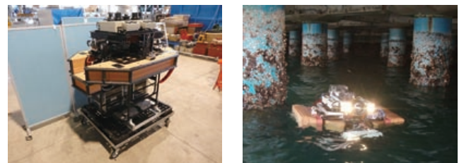
図-3 栈橋上部工点検調査用ROV
