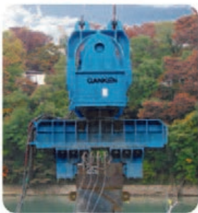
長時間運転可能な水冷式電動パイラーです
