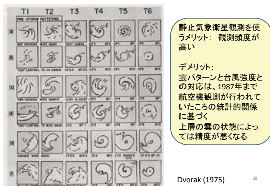
図5 海上にある台風の強度推定：静止気象衛星観測による雲パターンから推定(ドボラック法)
