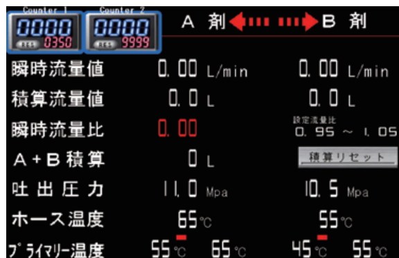
自動監視制御吹付システム
