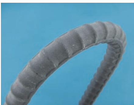
写真4 曲げ試験後のサンドグリッパー
