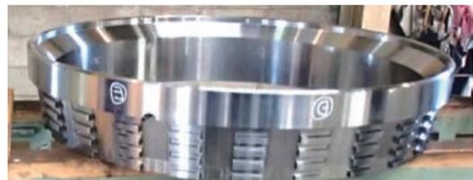
写真1 ピン継手
