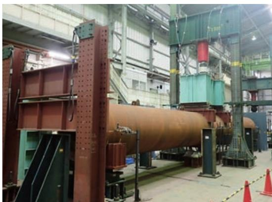
写真3 曲げ試験(外径1600mm, 板厚19mm, SKK400)
