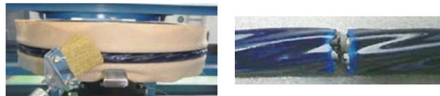
(a) 曲げ試験状況 (b) 引張破断試験後
