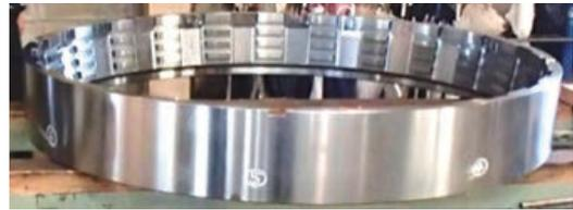
写真2 ボックス継手
