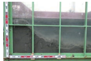
写真2 水中打設状況(勾配1:3)
