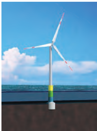
図-1 スカートサクシオンを用いた洋上風車イメージ
