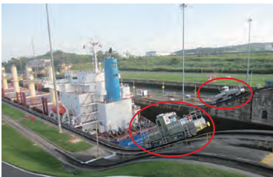
写真3(a) 曳航操船用電動機関車(ロコモティブ)
