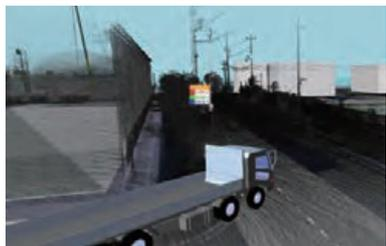
3Dスキャナーの点群データによる架空線との離隔確認
