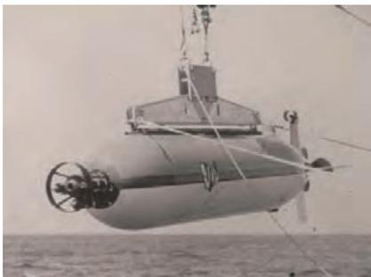
図1 ワシントン大学のやりきるロボット「SPURV」
