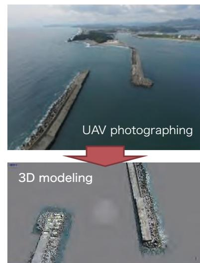
図-4 マルチコプター(UAV: Unmanned Autonomous Vehicle)の取得写真からモデリング
