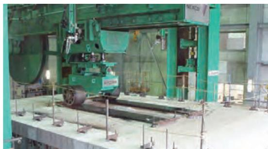
写真-1 輪荷重走行試験
