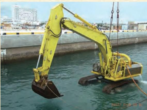
水中バックホウ実機(平良で稼働中の機体)
