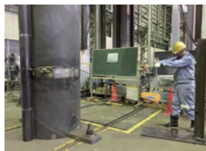
写真-3 鋼管矢板の接合試験(上:回転バンド、下:牽引工具)
