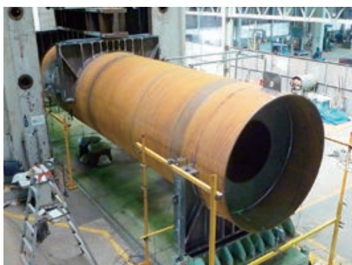
写真-2 4点曲げ試験(最大径φ2000mm)
