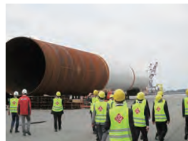
写真4 EEW Special Pipe Constructions社で製造されたモノパイル(ロストック港)
