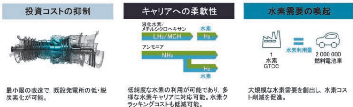
図2 水素焚きガスタービンにおける環境的、経済的メリット
